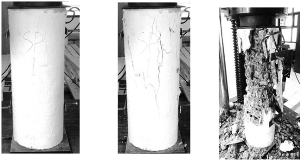
Gambar 7. Pola retak benda uji kolom lingkaran tulangan pengekuat standar/spiral
