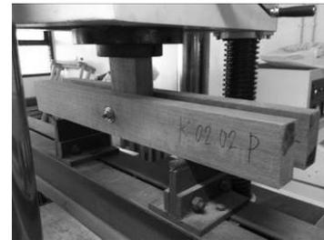
(b) Penempatan benda uji
