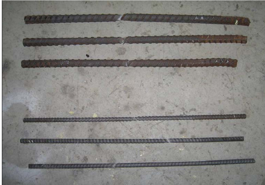
Gambar L2.7 Kondisi putus tulangan ulir
