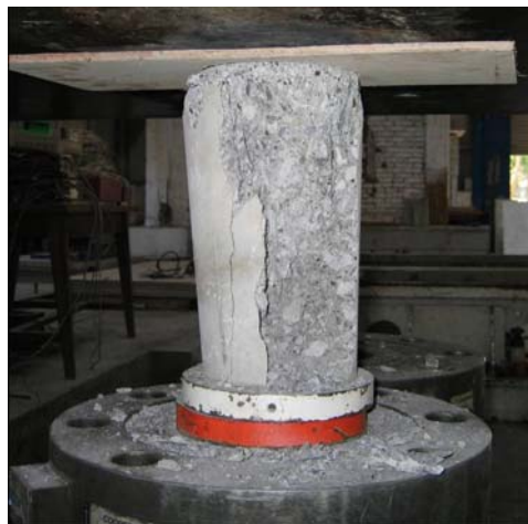
Gambar L2.4 Bentuk keruntuhan benda uji silinder beton
