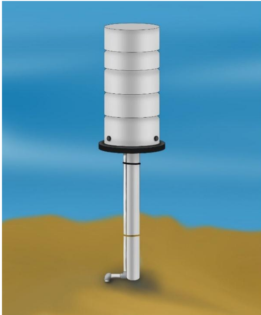
Gambar 3.6 AWS dengan Sensor Tipping Bucket (sumber: Kurniawan, A. 2020)
