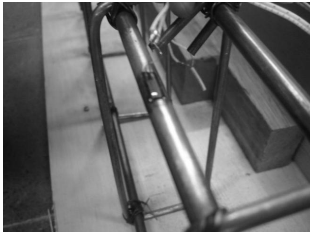
Gambar L5.4 Strain Gauge Telah Dilem
