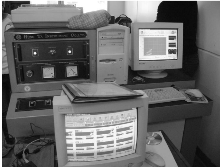
Gambar L5.16 Komputer yang membaca DC104R Controller dan UTM
