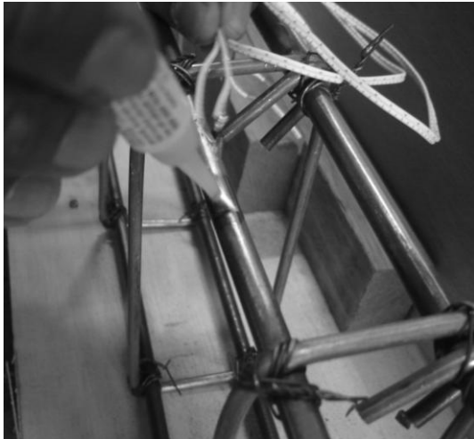
Gambar L5.3 Strain Gauge di lem Menggunakan Power Glue
