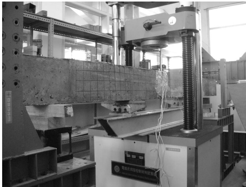
Gambar L5.15 Beban terpusat dibagi menjadi dua beban terpusat
