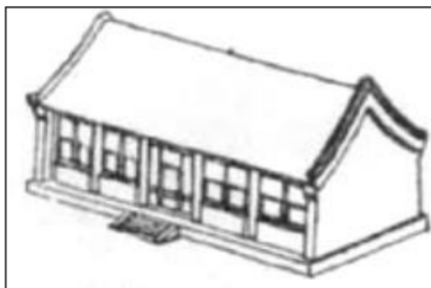
Gambar 2. Bentuk atap Ngan Shang Ti atau atap Pelana
