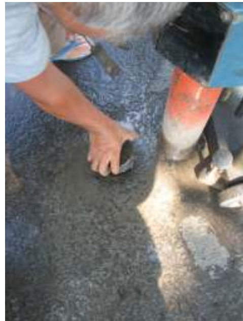
Gambar 3 & 4 Pengambilan Benda Uji Setelah Pengeboran
