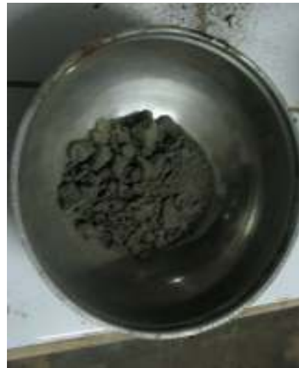
Gambar 22 Agregat Setelah Diekstraksi
