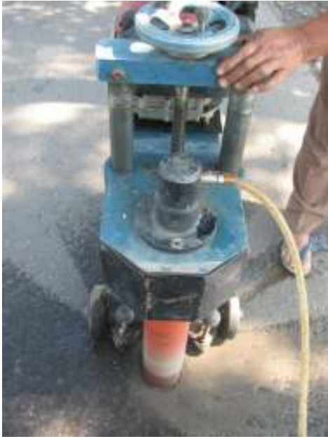
Gambar 1 & 2 Pengeboran Benda Uji Dengan Alat Core Drill
