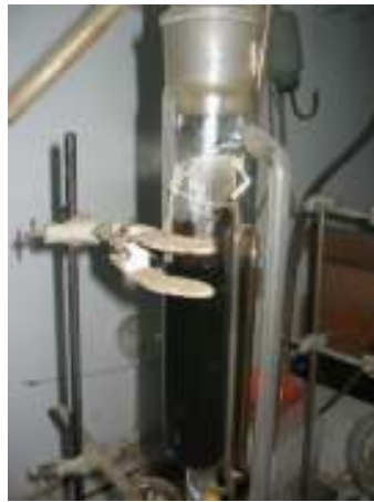
Gambar 15 & 16 Ekstraksi Dengan Alat Soklet
