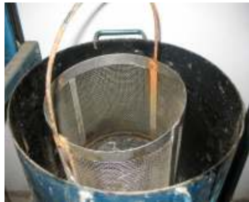
Gambar 9 & 10 Penimbangan Benda Uji Di Dalam Air
