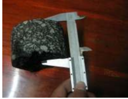
Gambar 5 & 6 Pengukuran Benda Uji
