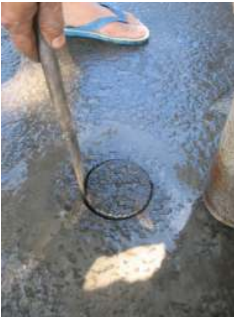
Gambar 3 & 4 Pengambilan Benda Uji Setelah Pengeboran
