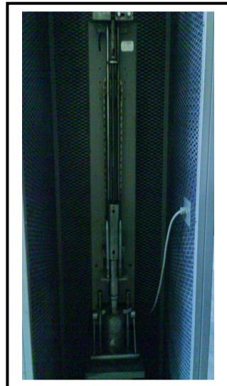
Gambar L7.6 Alat Penumbuk Otomatis (*compactor*)
