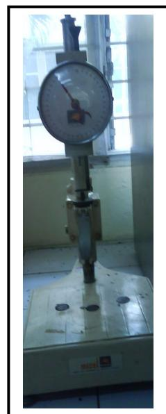
**Gambar L7.1.4 Alat Penetrasi**
