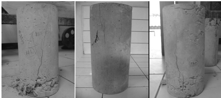
14 hari Beton Normal 310 KN
