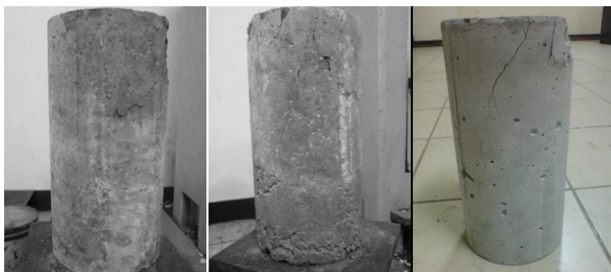
28 hari Beton Normal 400 KN
