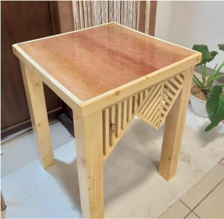
Gambar 7. Table Top Berbahan Dasar Serat Sabut Kelapa. Sumber: Putri (2020: hal.10)
