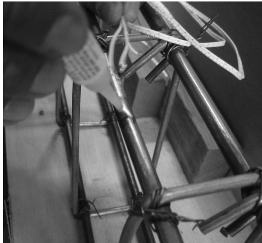
Gambar L5.3 Strain Gauge di lem Menggunakan Power Glue
