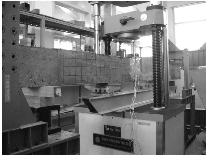
Gambar L5.15 Beban terpusat dibagi menjadi dua beban terpusat
