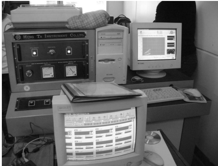
Gambar L5.16 Komputer yang membaca DC104R Controller dan UTM
