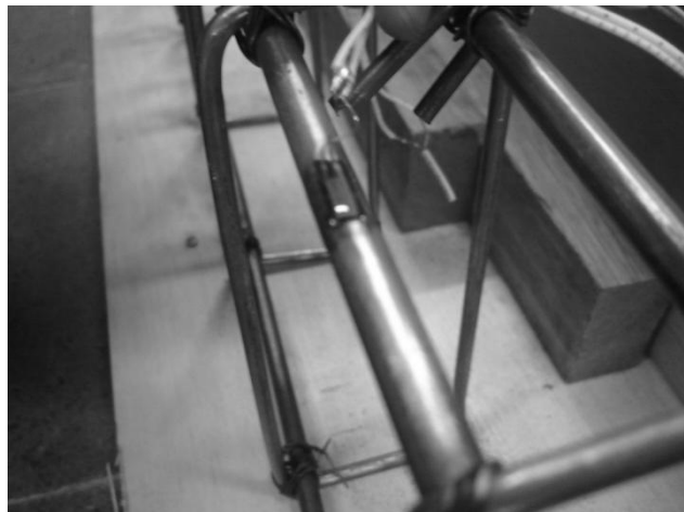
Gambar L5.4 Strain Gauge Telah Dilem
