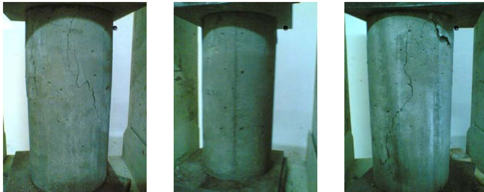
Gambar kerusakan sampel beton dengan batu api 100% umur 7 hari
