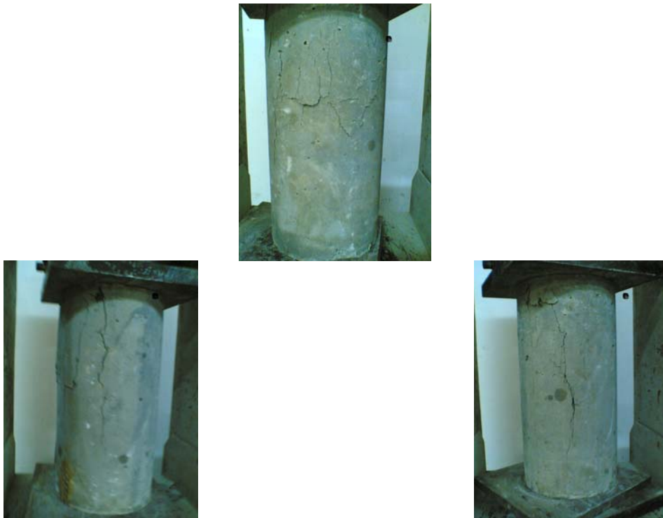
Gambar kerusakan sampel beton dengan agregat kasar umur 28 hari
