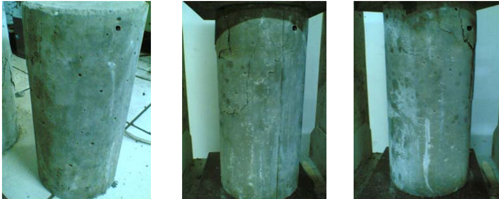
Gambar kerusakan sampel beton dengan batu api 30% umur 7 hari
