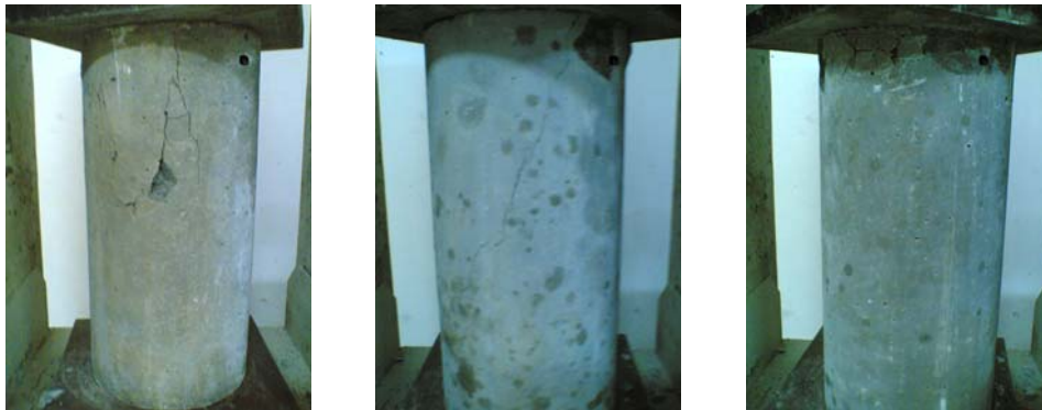
Gambar kerusakan sampel beton dengan agregat kasar umur 14 hari
