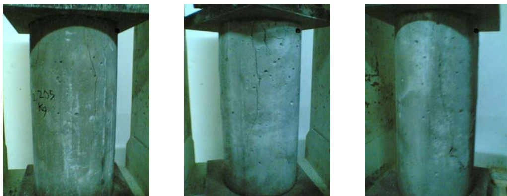
Gambar kerusakan sampel beton dengan batu api 50% umur 14 hari
