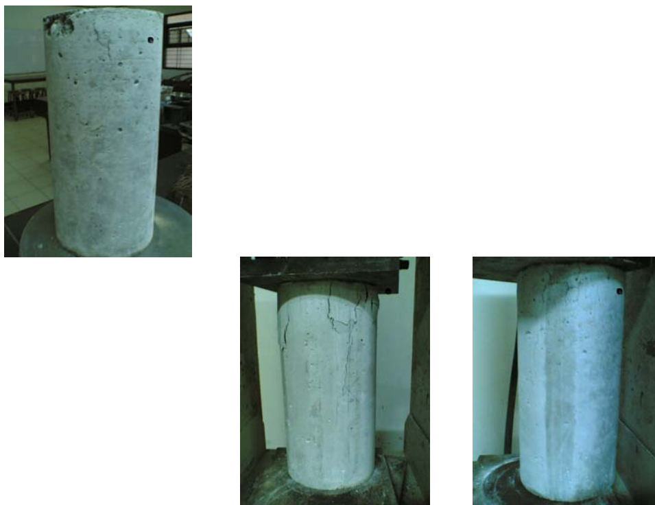
Gambar kerusakan sampel beton dengan batu api 10% umur 28 hari
