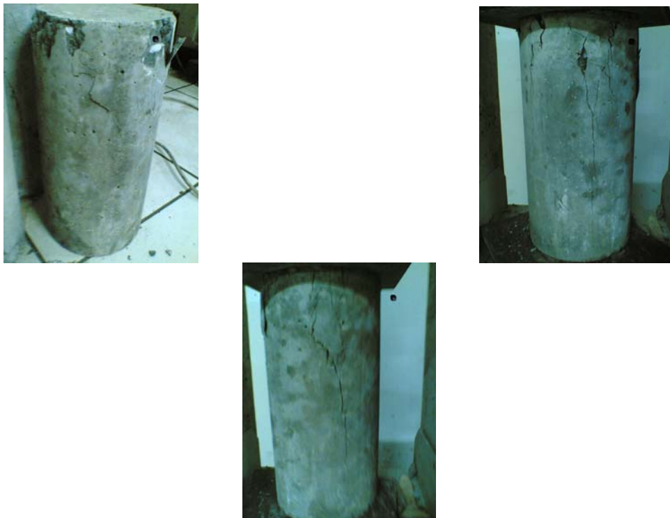
Gambar kerusakan sampel beton dengan batu api 30% umur 14 hari
