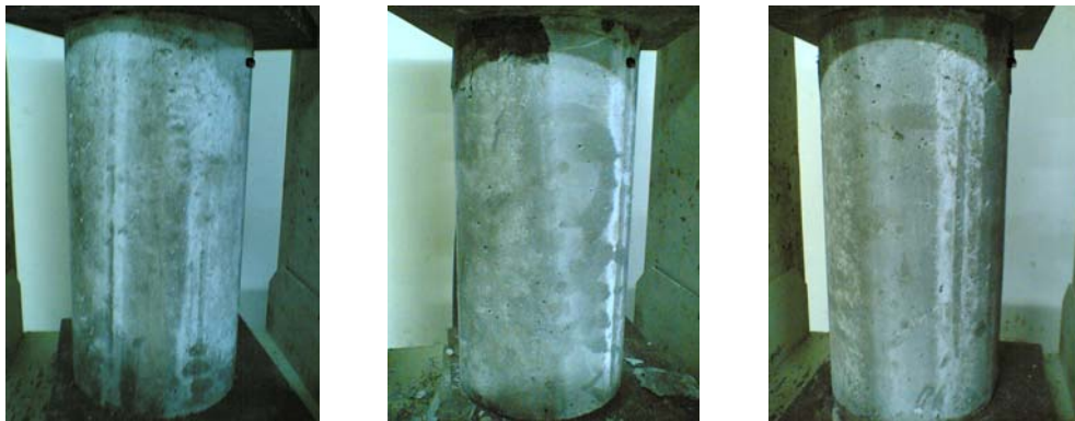
Gambar kerusakan sampel beton dengan batu api 10% umur 14 hari
