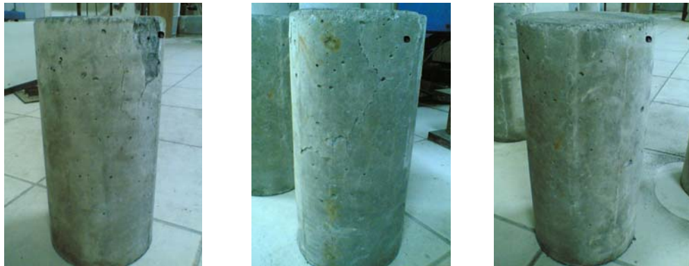
Gambar kerusakan sampel beton dengan batu api 50% umur 7 hari
