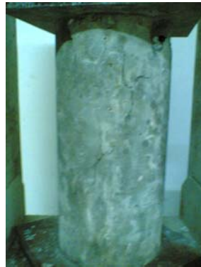
Gambar kerusakan sampel beton dengan batu api 100% umur 14 hari
