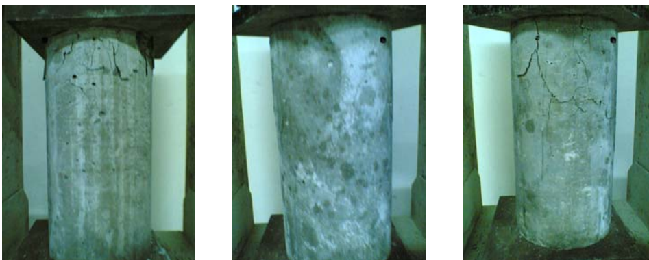
Gambar kerusakan sampel beton dengan batu api 10% umur 7 hari
