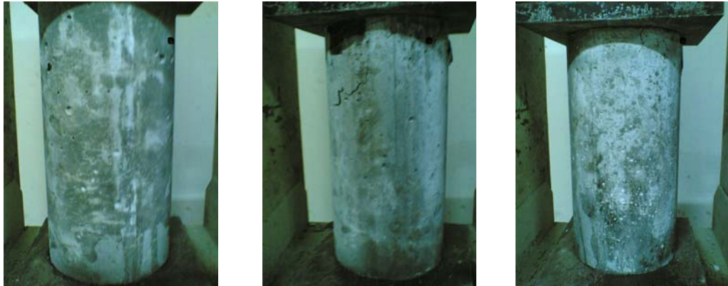
Gambar kerusakan sampel beton dengan batu api 30% umur 28 hari
