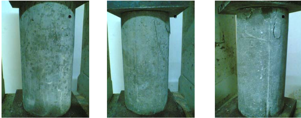
Gambar kerusakan sampel beton dengan agregat kasar umur 7 hari
