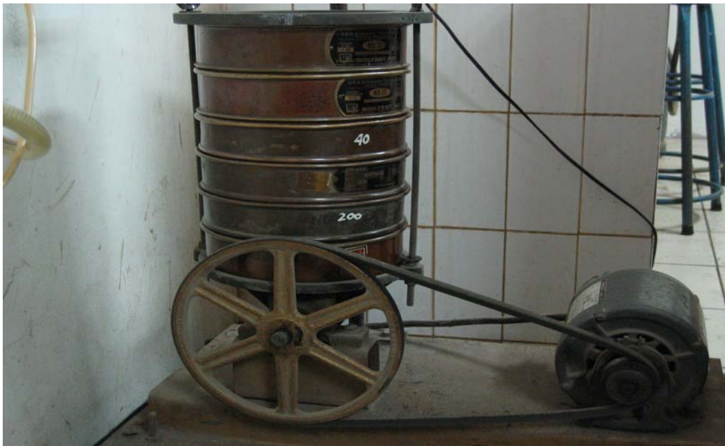
Gambar C.2 Satu Set Ayakan Dan Mesin Pengguncang
