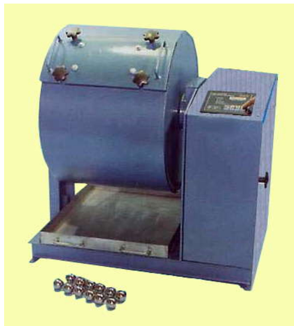
Gambar L.8 Mesin Abrasi Los Angeles
