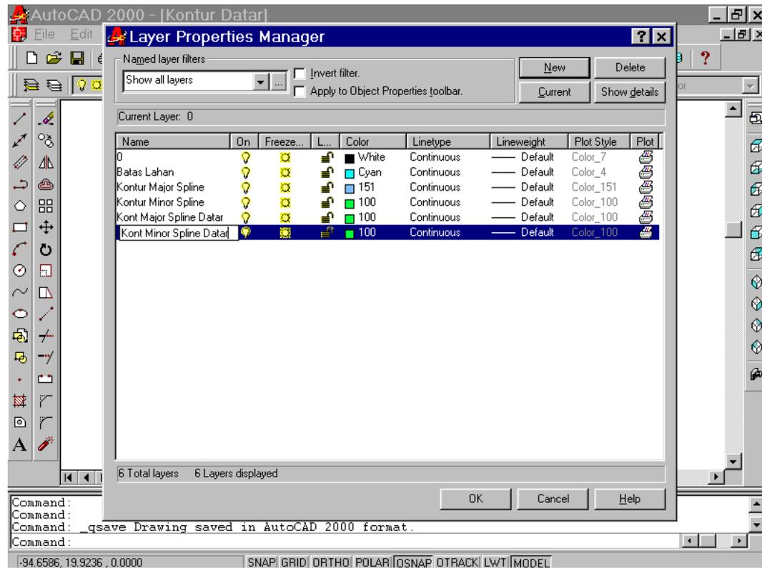
Penjelasan: Pembuatan *New Layer* (Kontur Major Spline Datar dan Kontur Minor Spline Datar) untuk pembuatan gambar kontur sebagai gambar datar
