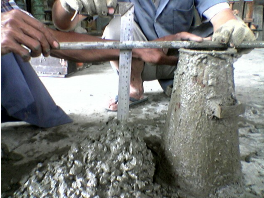
Lampiran 33. Situasi pengukuran nilai slump
