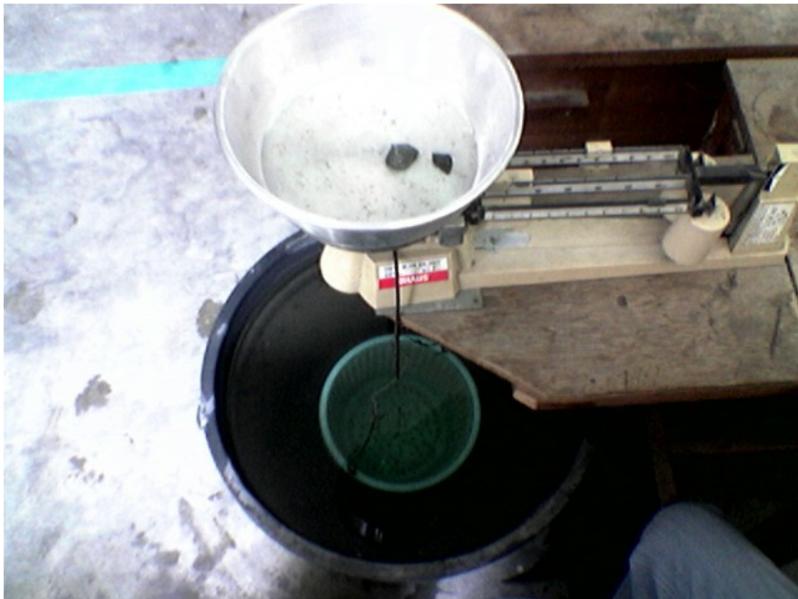
Lampiran 24. Alat timbang sederhana untuk mengukur berat isi batu pecah
