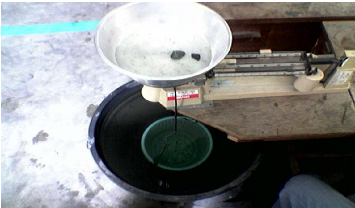
Gambar 2 Alat timbang sederhana untuk mengukur berat isi batu pecah
