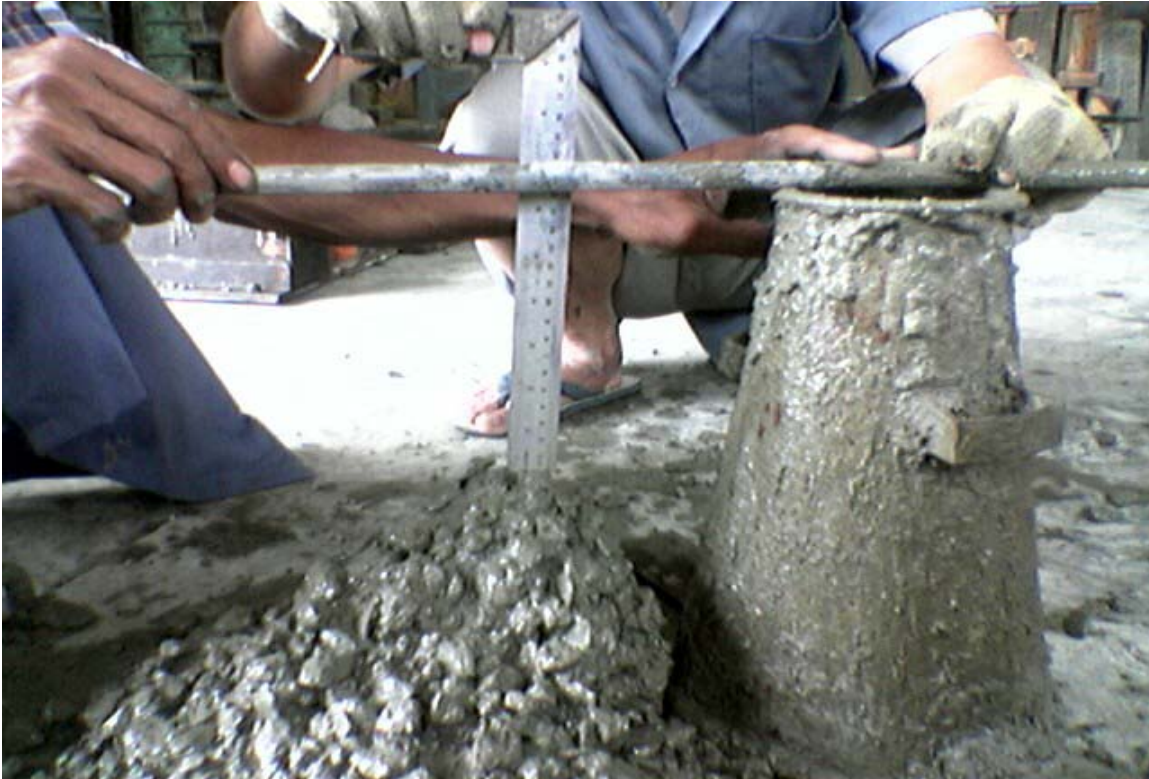
Gambar 11 Situasi pengukuran nilai slump
