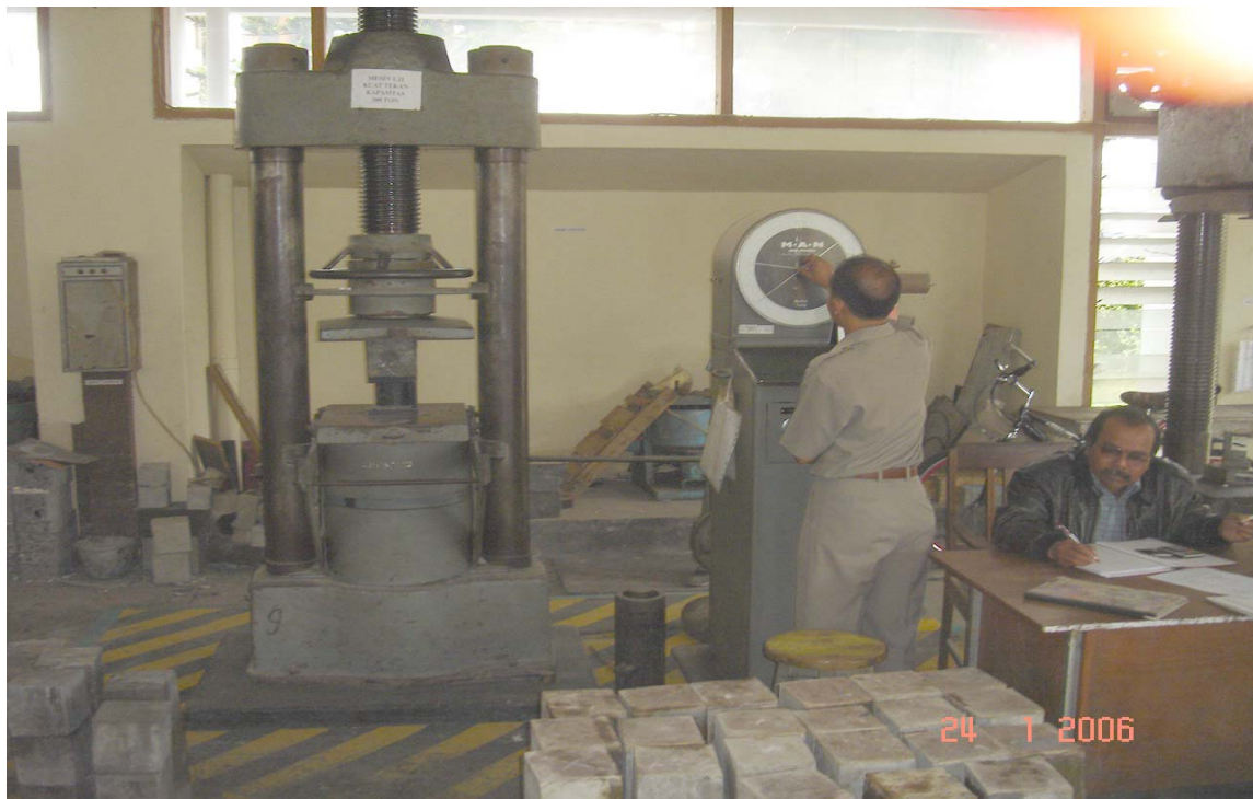
Gambar 14 Situasi pengujian kuat tekan beton
