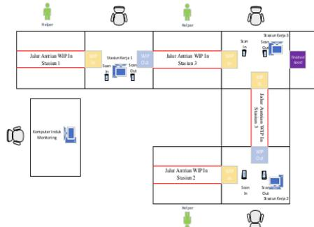
Gambar 6. Layout Lintasan Produksi
