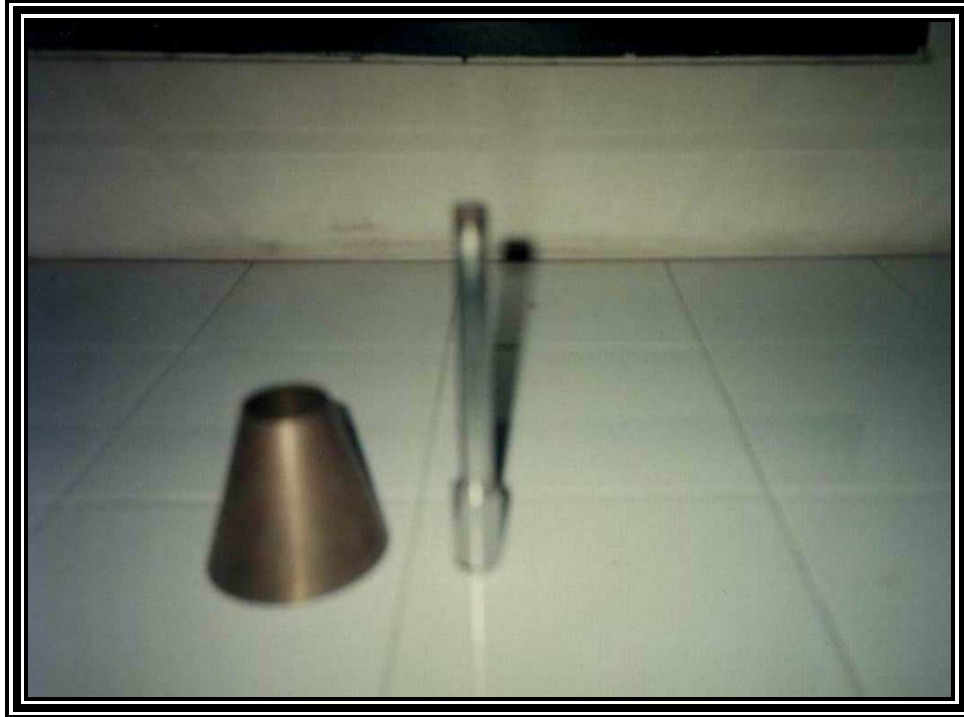
Kerucut Terpancung untuk Menentukan Keadaan SSD Agregat Halus
