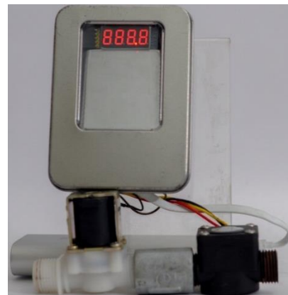
Gambar 14 Realisasi Perangkat Keras Water Meter
