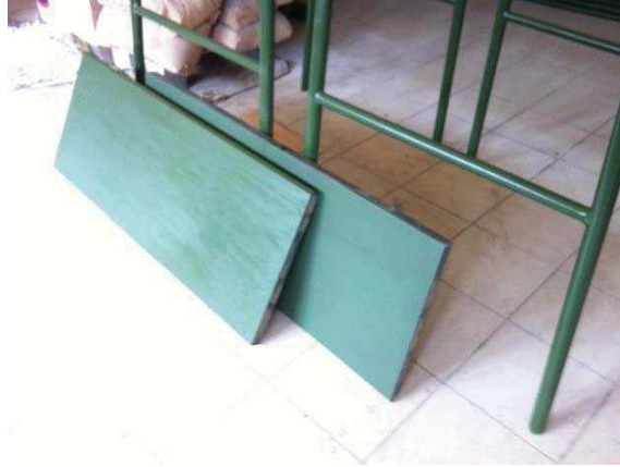
(a). Papan pelat besi untuk bekisting.
