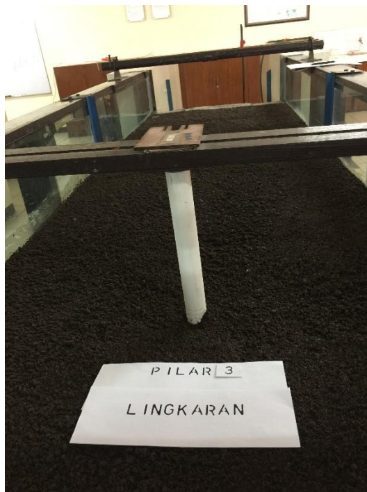
Gambar L.1.4 Pemasangan Pilar Berbentuk Lingkaran Berdiameter 4cm dengan tanpa LWD
