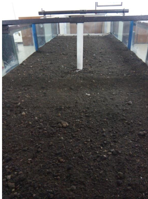
Gambar L.1.6 Pemasangan Pilar Berbentuk Lingkaran Berdiameter 4cm dengan LWD Seajar Sedimen
