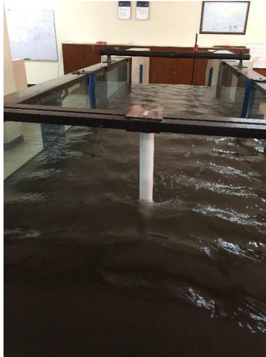
Gambar L.2.1 Pengaliran Saluran Terbuka dengan Pilar Berbentuk Lingkaran Berdiameter 4cm
