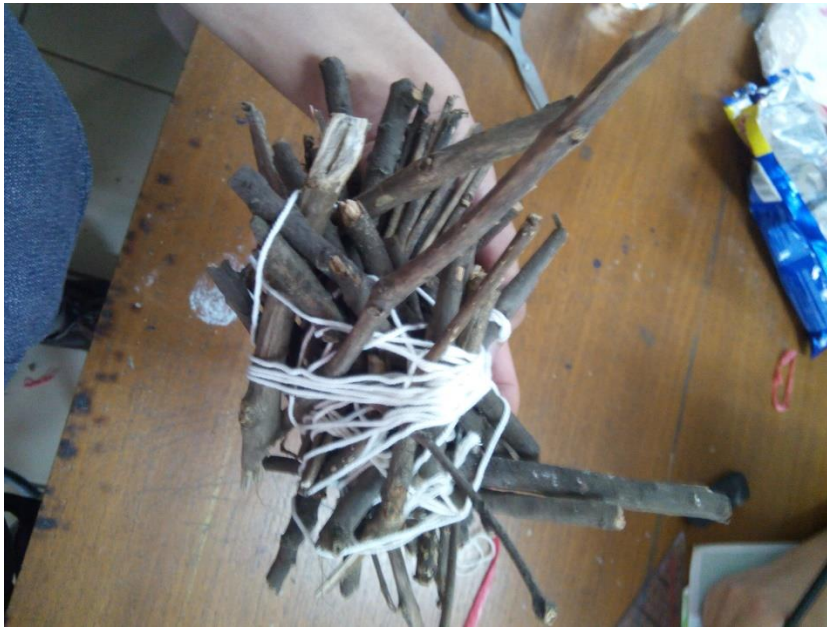
Gambar L.1.3 Pembuatan Large Woody Debris (LWD)
