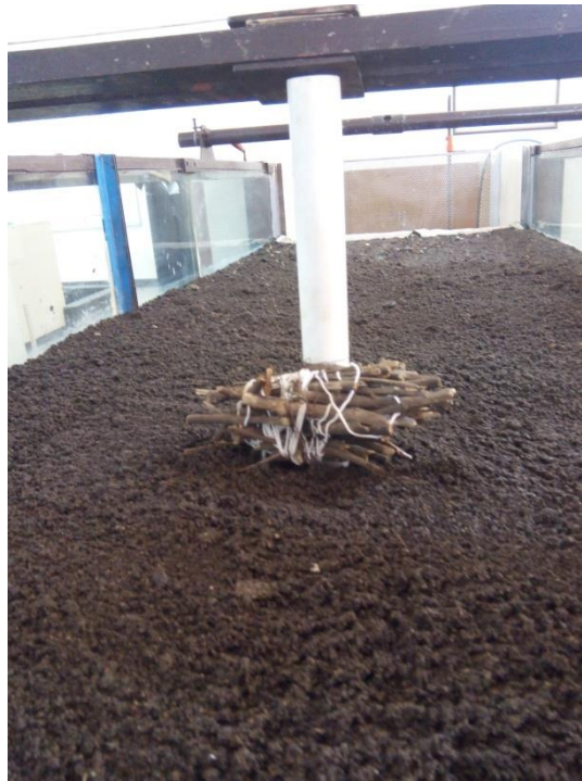
Gambar L.1.5 Pemasangan Pilar Berbentuk Lingkaran Berdiameter 4cm dengan LWD Seajar Muka Air
