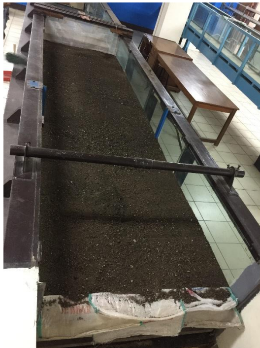
Gambar L.1.2 Tampak Atas Saluran Terbuka dengan Sedimen
