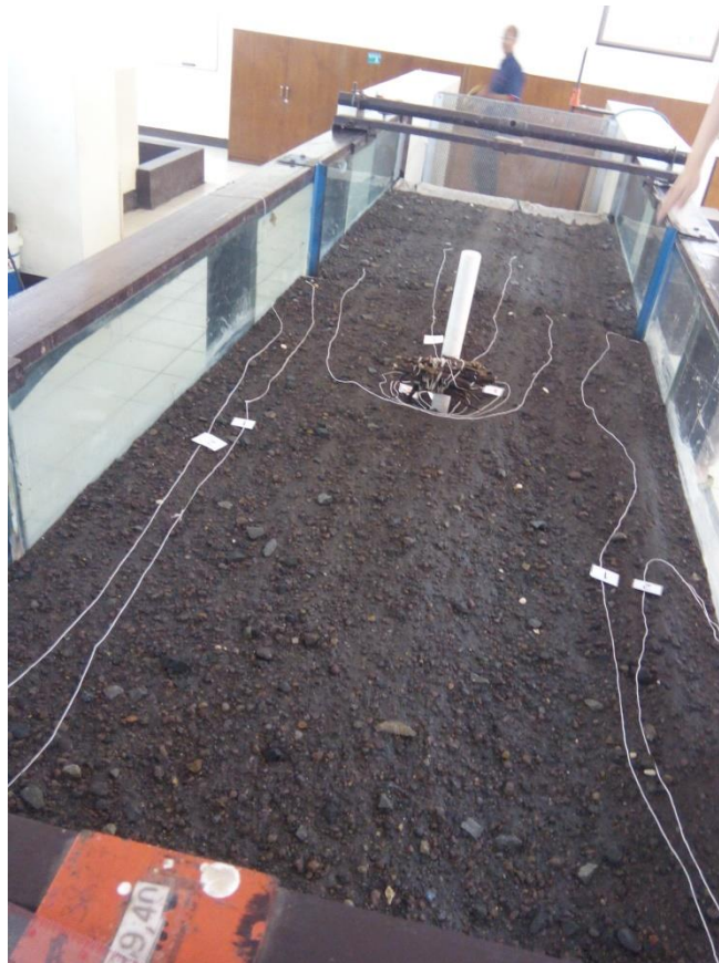
Gambar L.3.1 Pola Penggerusan Pilar Berbentuk Lingkaran Berdiameter 4cm dengan LWD Seajar Muka Air
