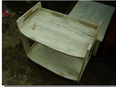
Proses Pendempulan Awal (menutupi pori-pori )
