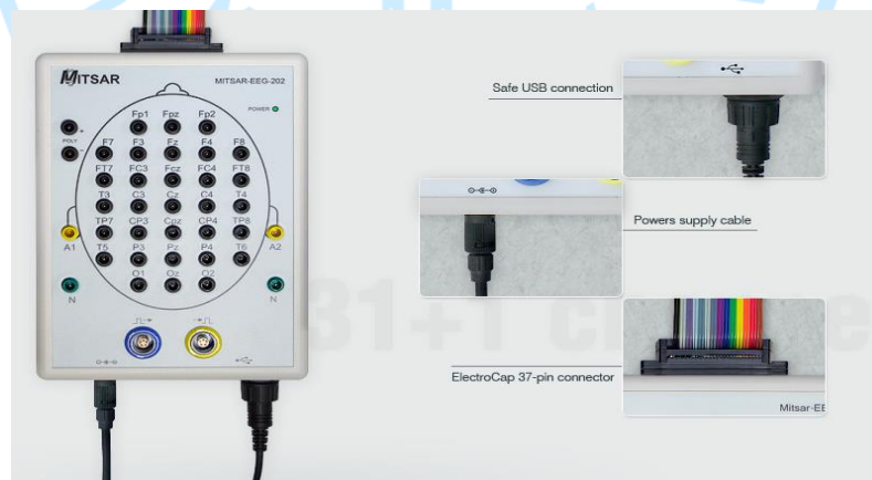
Gambar II.6 Mitsar EEG-202, 31 Kanal [14]
