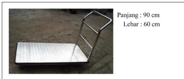
Gambar 10. Usulan Alat *Material Handling* Untuk Gudang Bahan Baku & Stasiun Pemotongan
