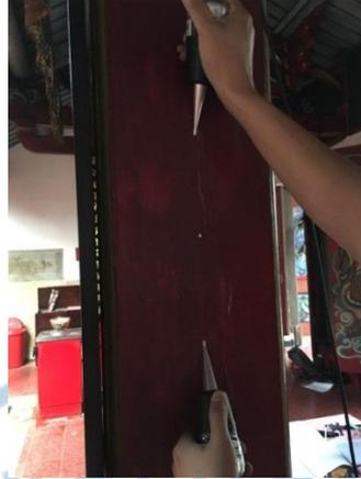
**Gambar 1.3 Penggunaan *Sylvatest Trio* Pada Pengukuran Kolom**
