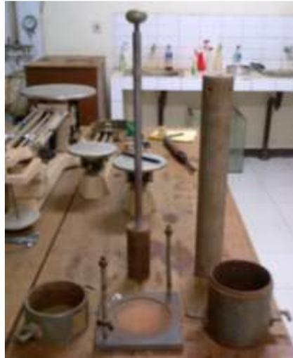
Gambar 1. Alat uji Kompaksi Proctor Standar
