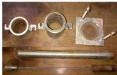
Gambar 2. Alat uji Kompaksi Non Standar
