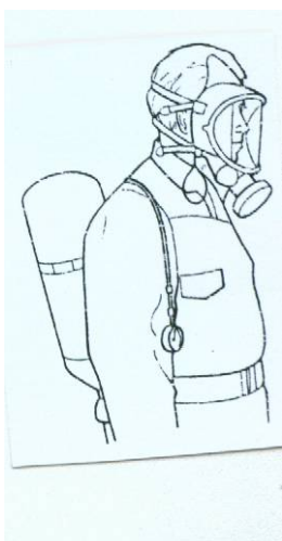
Alat pernapasan yang dapat mengisi sendiri menggunakan tabung udara atau oksigen.(J.M. Harrington & F.S Gill, 2003)
