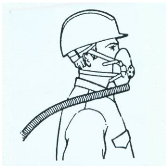
Alat saluran udara segar, pasokan udara segar dimasukkan ke dalam muka, topeng atau baju melalui satu pipa lentuk berdiameter lebar.(J.M. Harrington & F.S Gill, 2003)
