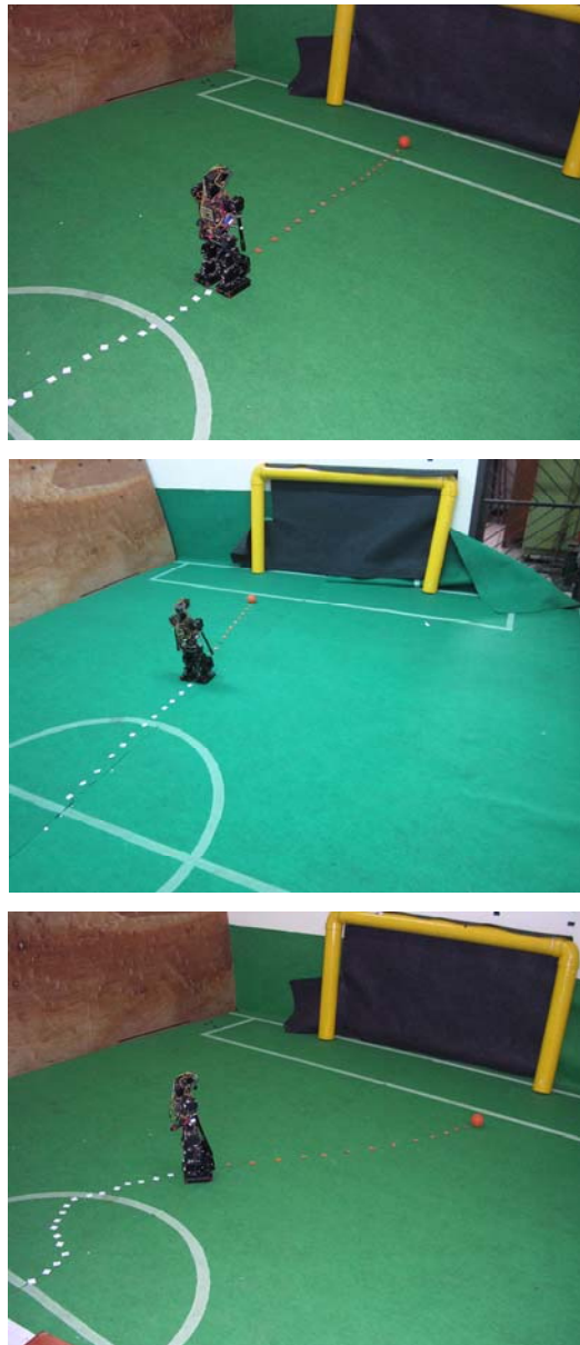
Gambar 4.3 Lintasan Robot menuju bola yang berada searah gawang
