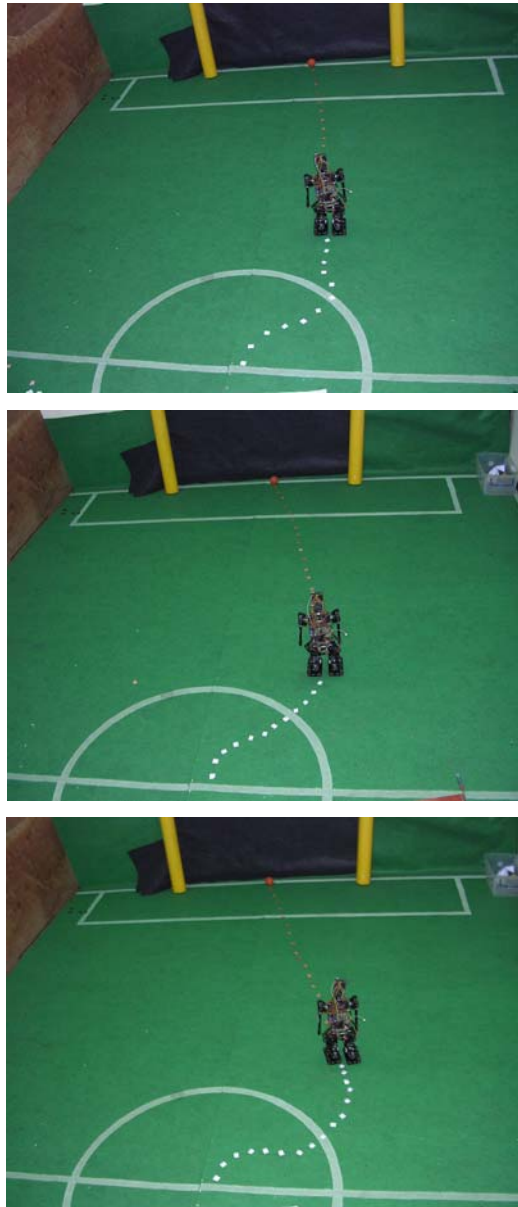
Gambar 4.4 Lintasan Robot menuju bola yang berada di sebelah kiri gawang
