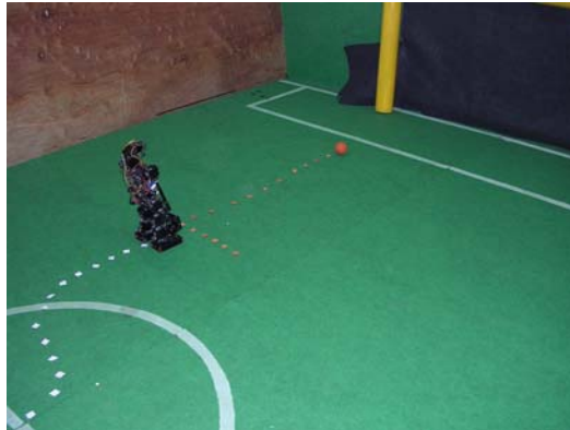
Gambar 4.7 Lintasan Robot terhadap pemindahan bola dari sebelah kanan gawang menuju ke kanan
