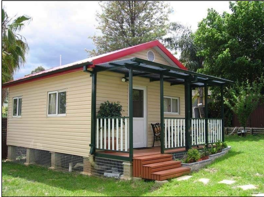
Gambar 1.3 Rumah Modular dari Baja Ringan
