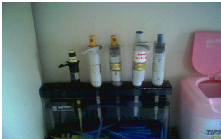
Gambar L2.2. Berbagai Ukuran Miropipet
