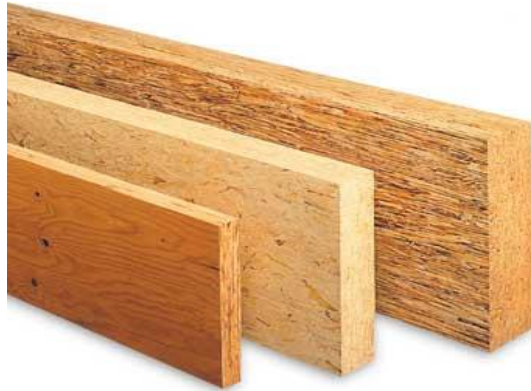
Gambar 1.3 Contoh Kayu Laminated Veneer Lumber 3 (sumber: http://www.structuremag.org/images/0807-pw-2.jpg , diakses pada tanggal 28 April 2014)
