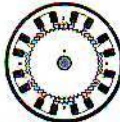
Gambar 6 Penampang melintang dari motor *stepper* tipe *hybrid*
